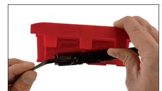
Bei Stromkreiserweiterung oder Klemmen-austausch: Gelbox öffnen, Gelreste von der Klemme entfernen, neu bestücken und Gelbox schließen.
