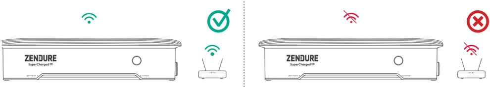
Das Antennengehäuse am Gerät muss einen Abstand von mindestens 15 cm zur Wand aufweisen.
