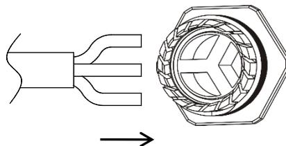
d. Drehen Sie die Mutter mit 3.3N·m bis der Verriegelungsmechanismus auf die Basis trifft.
